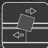
Через 3 часа обработать стыки мелкой наждачной бумагой. Для идеальной маскировки, при необходимости, повторить шаги 1 и 2.
